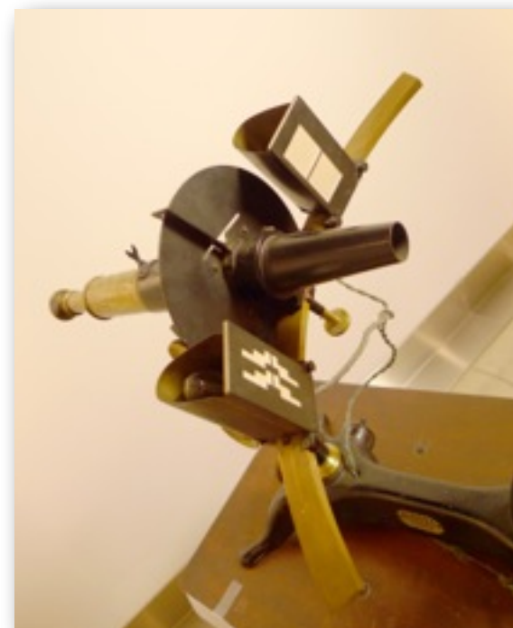
Figura 7. Oftalmómetro de Javal. El observador hace ejecutar una rotación de 90^\circ al anteojo para la determinación del segundo meridiano principal
