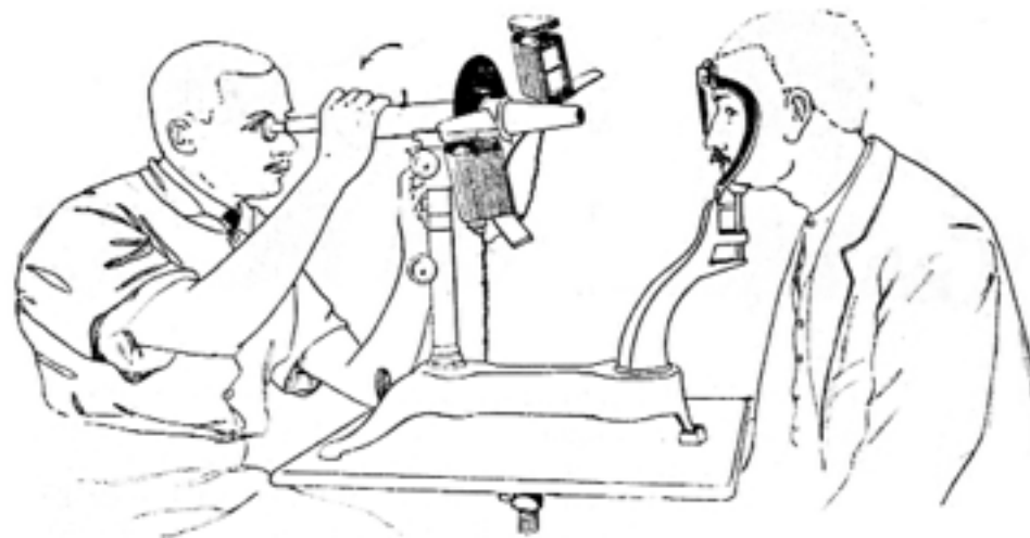
Figura 7. Oftalmómetro de Javal. El observador hace ejecutar una rotación de 90^\circ al anteojo para la determinación del segundo meridiano principal
